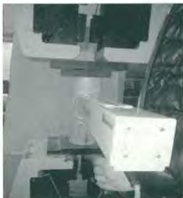
图 1 微钻阻力值试验
